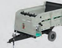
**SMV 5.0:** Capacidade de carga de 5m<sup>3</sup>, possui um eixo central com duas rodas.
