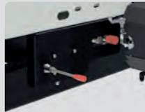
A escolha da descarga dianteira ou traseira é feita pelo movimento de um comando de alavanca e a Regulagem da velocidade de descarga por registro hidráulico.
