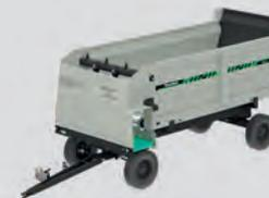
**SMV 10.0 Direção:** Capacidade de carga de 10m<sup>3</sup>, possui um eixo traseiro e um eixo dianteiro com direção e o total de quatro rodas.
