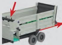
Desligamento automático dos rolos afoadores para quando ligado o modo de descarregamento traseiro.
