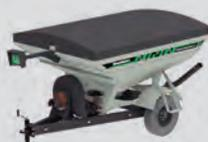
**TP 1.4:** Possui sistema de engate na barra de tração (arrasto) do trator e um eixo com duas rodas e pneus, suportando seu próprio peso.
