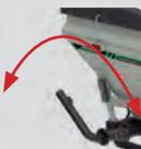
Lançamento bidirecional, possibilita inverter o lado de lançamento sem que o operador desça do trator.
