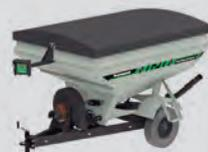
**TP 2.0:** Possui sistema de engate na barra de tração (arrasto) do trator e um eixo com duas rodas e pneus, suportando seu próprio peso.
