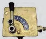
Exclusivo sistema hidráulico para a dosagem de ração. Com o movimento de apenas uma alavanca é possível regular a quantidade de ração a ser lançada.
