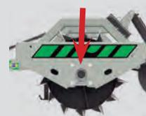
Pontas de eixo reforçadas, com 70 milímetros de diâmetro e rolamentos auto alinhantes de linha agrícola.
