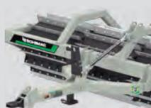
Cabeçalho, com ajuste de altura para o nivelamento preciso do implemento em relação ao trator, e posição retrátil que reduz suas dimensões ao ser recolhido em barracões.
