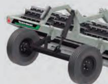
Sistema de transporte, com cilindro de levante e calço de segurança garantindo a estabilidade no transporte.
