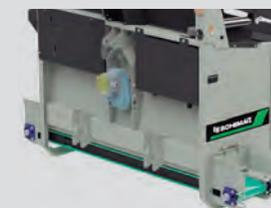
**Esteira de descarga:** Com esta opção a descarga pode ser realizada para ambos os lados do implemento.
