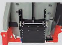
Chassi separado do compartimento de carga, proporciona maior precisão na pesagem da dieta, independente da posição da máquina ou da fresa.
