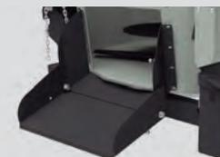
**Adição de comporta de descarregamento:** Possibilita a descarga por gravidade para ambos os lados.
