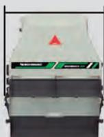
Fresa de carregamento grande, capaz de retirar a silagem nas laterais do silo.
