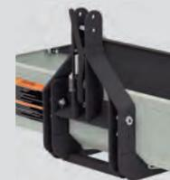
**Descarga manual:** O destravamento para descarregar a carga é feito manualmente ao puxar uma alavanca. Proporciona baixo custo de aquisição e manutenção.
