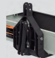
**Descarga hidráulica:** Maior facilidade na operação de carga e descarga, além de possibilitar a descarga parcial de produtos que o modelo manual não permite.
