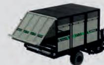
Para descarregar a tampa traseira se abre automaticamente e as esteiras inferiores transportam para fora toda a carga em menos de 2 minutos.
