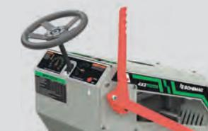
Alavanca para levantar e abaixar a lâmina dianteira com a mão direita.
