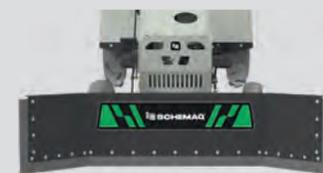
Lâmina com 0,35m de altura e 1,55m de largura, com borracha na parte inferior e laterais.
