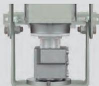
Controle limitador de torque, sistema de proteção que desliga o rotor em caso de travamento.
