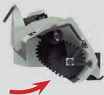
Sistema de enleiramento com dois rotores, sendo o superior liso e o inferior dentado, que ajuda a tritura a cama, proporcionando maior eficiência mesmo nas camas com maior profundidade.
