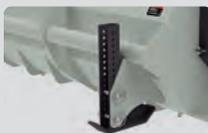
Guia controlador de altura com vários níveis de regulação, proporciona maior precisão e nivelamento na operação, mantendo a altura selecionada.
