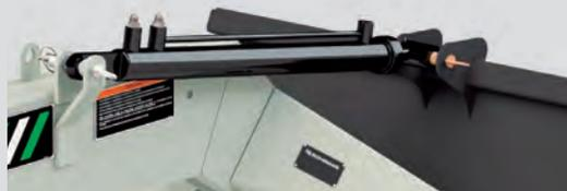
**Guincho:** Facilita o transporte de diversos tipos de cargas. Tem a capacidade de até 500 Kg, não precisa retirar a concha para a sua utilização, e quando equipada com cilindro hidráulico, o mesmo tem a função de esticar e encolher a lança através do comando do trator.
