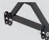
Regulagem Vertical que se ajusta a diversos modelos de trator. Tem a finalidade de atingir a altura de levante da concha de até 3 metros.
