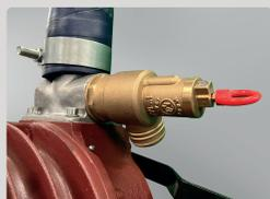
**Válvula de segurança**, mantém a estabilidade operacional protegendo o tanque contra excesso de pressão.
