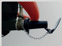
**Válvula de carga e descarga em latão**, maior durabilidade e resistência contra corrosão.
