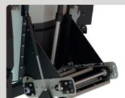
**Sistema de esteira para o descarregamento**, Proporciona regulagem de altura da descarga e melhor uniformidade do trato no cocho, podendo ser para um único lado ou ambos os lados.
