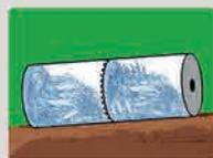
**Sistema de lastreamento**, utiliza câmaras separadas, que podem ser preenchidas com água, garantindo uma distribuição uniforme do peso sobre o solo, mesmo em terrenos inclinados.
