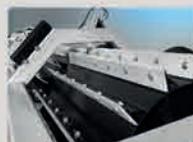
**Possui de série, facas em aço temperado**, reversíveis que podem ser usadas em ambos os lados para cortar ou estrangular a cobertura, e dispostas de forma desencontrada no rolo, melhorando a eficiência na rolagem.
