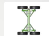
**Sistema de rodado Tandem**, possui um eixo tandem com quatro rodas e "macaco" no cabeçalho frontal.
