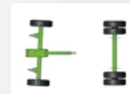
**Sistema de rodado com Direção**, possui um eixo com rodado duplo na traseira (4 rodas) e um eixo direcional na dianteira (2 rodas).
