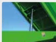
**Sistema basculante com cilindro de três estágios**, requer menor esforço do trator para bascular a caçamba e não contamina o óleo hidráulico dos tratores.
