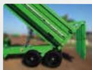
**Tampa traseira com abertura basculante**, descarga rápida com versatilidade e praticidade.
