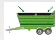
**Sobre caixa lateral**, aumenta a capacidade de carga em volume para 9,3 m<sup>3</sup>.
