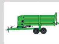
**SMV 10.000 Tandem,** capacidade de carga de 10m<sup>3</sup>, possui um eixo central, modelo tandem com quatro rodas.
