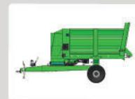
**SMV 5.000,** capacidade de carga de 5m<sup>3</sup>, possui um eixo central com duas rodas.
