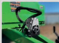
**Exclusivo sistema de transmissão hidráulico,** baixo ruído, dispensa o uso de pino fusível pois conta com válvula de segurança para travamentos e elimina o uso de Cardan facilitando a acoplagem em diversos modelos de tratores.
