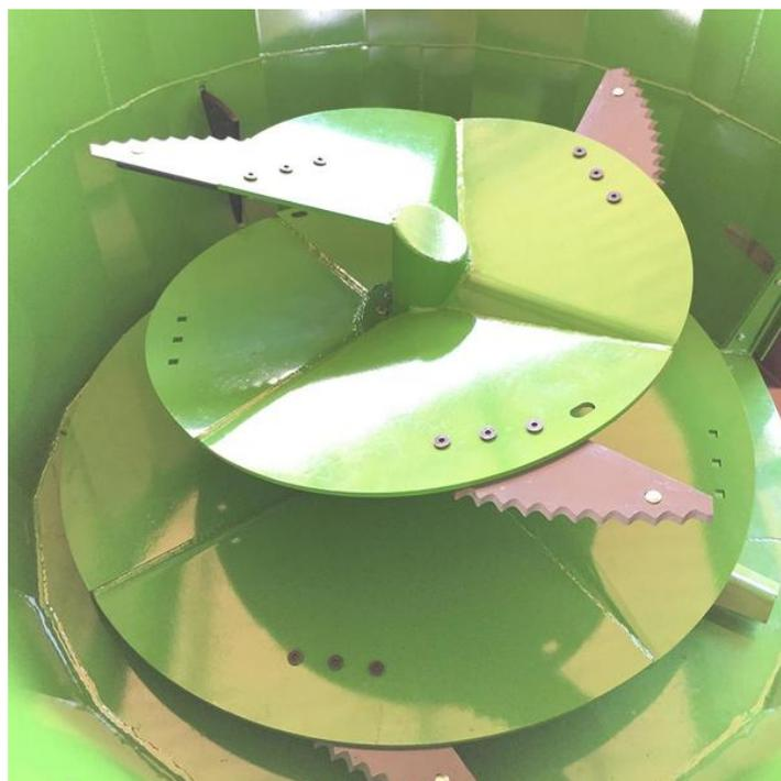
Figura 2.2 – Misturador helicoidal.
