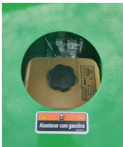
Figura 6.4 – Tanque de combustível.
