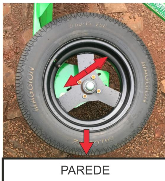
Figura 5.3 – Ajuste da roda.
