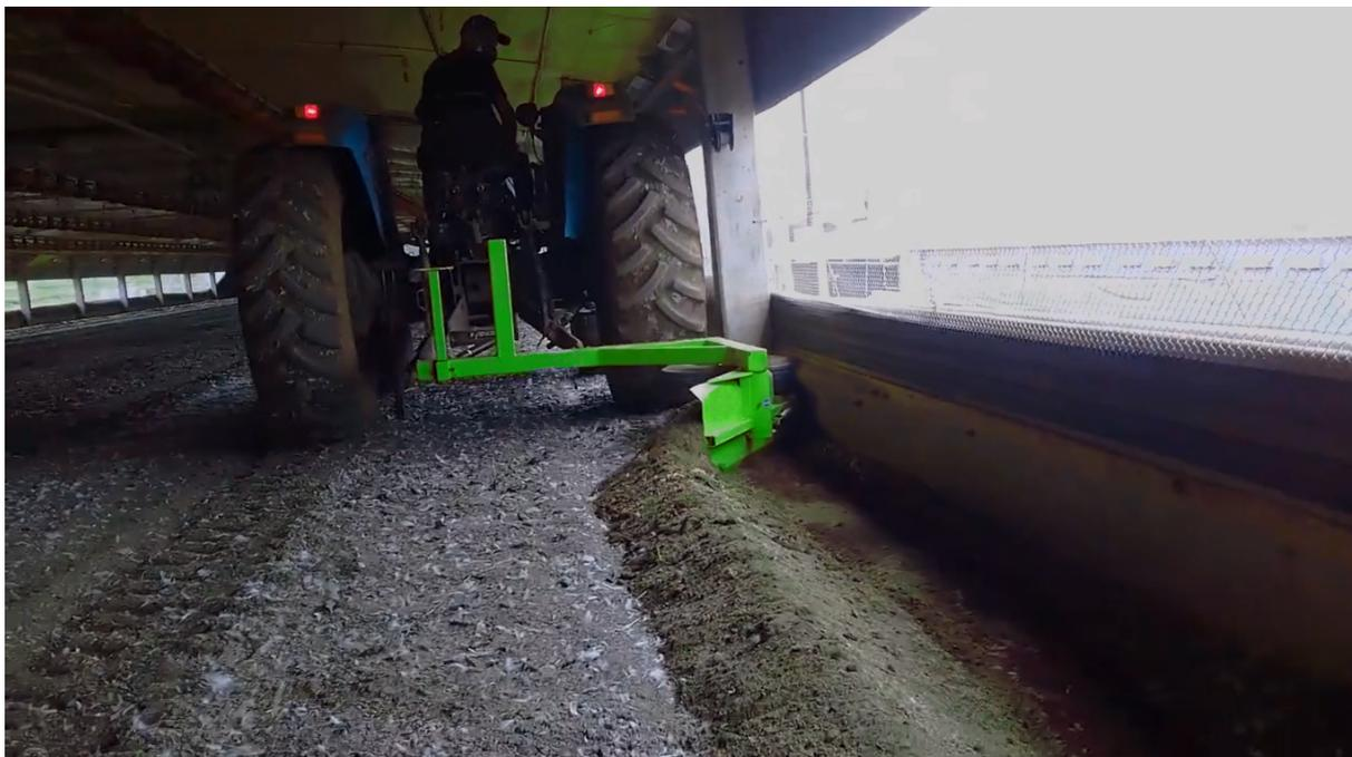
Ajuste de posição da lâmina raspadora: Permite direcionar o material raspado para ambos os lados.
