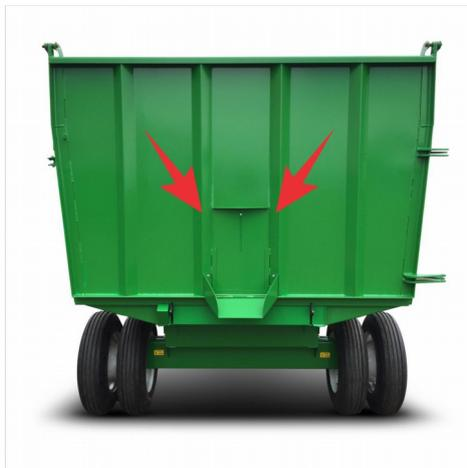
Figura 4.4 – Bica de descarga.
