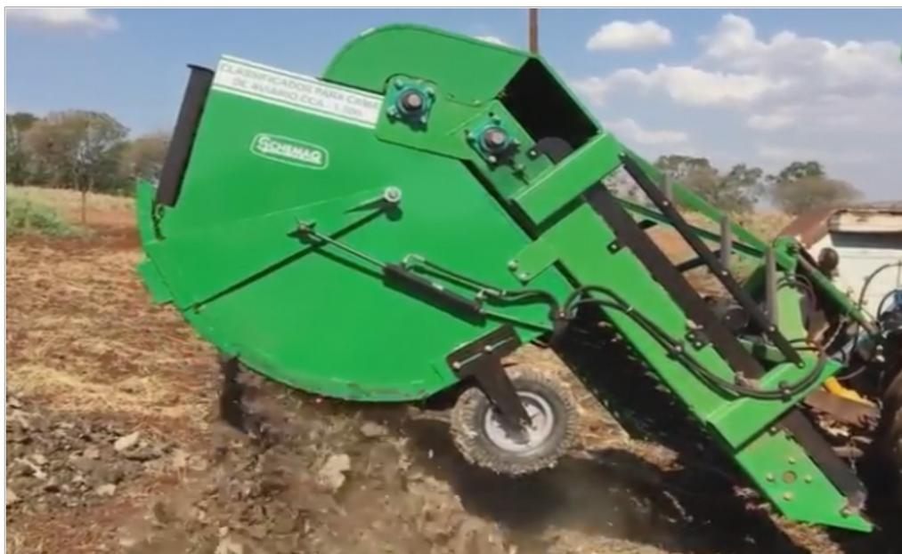
2. Nos modelos **CCA 3.000** e **CCA 4.500** o descarregamento funciona inicialmente movendo a caixa de carga para trás até o fim de curso do pistão e então ela bascula abrindo a tampa por gravidade. O acionamento dos cilindros é dado no comando hidráulico do trator.
