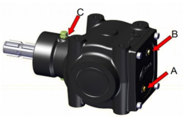
Após retirar todo o óleo lubrificante, recoloque o parafuso do dreno (A) e abra o parafuso do suspiro (C). Com a ajuda de um funil adicione o óleo lubrificante SAE 90 pelo orifício do suspiro até que o óleo fique visível no nível de óleo (B). Recoloque o suspiro de óleo (C) e o parafuso do nível de óleo (B).
